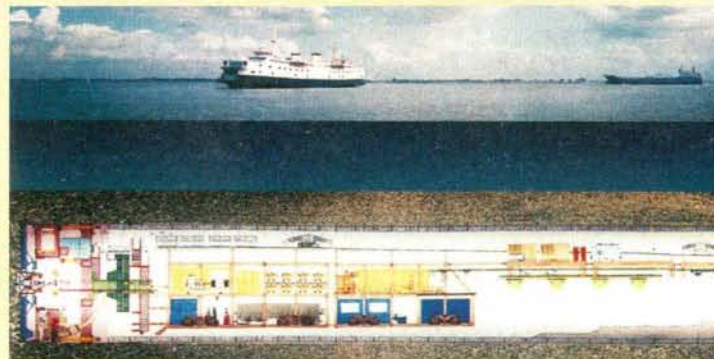
Примена "муљног штита" у изградњи подводног тунела
