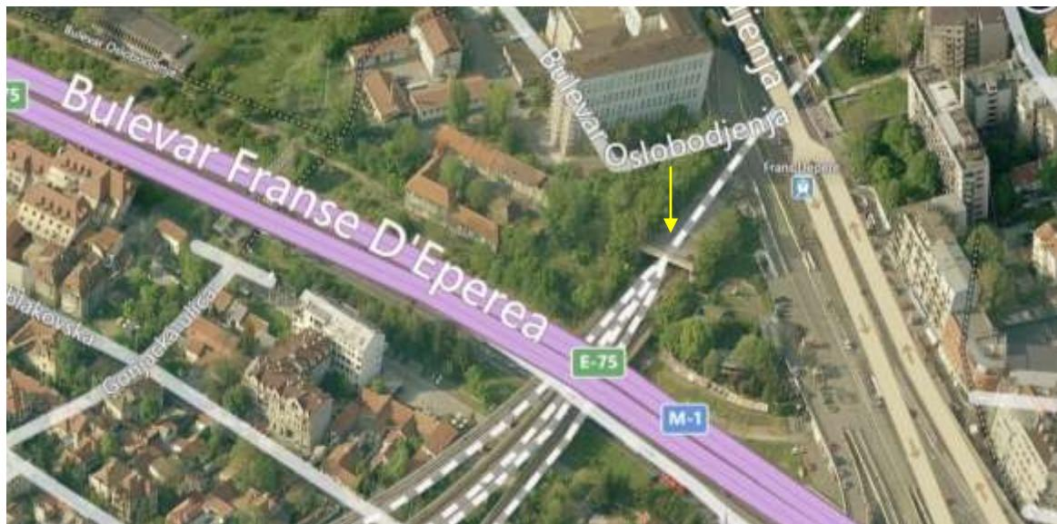
Na samom ulazu u tunele Vračar, a na izlaznoj strani mašinskih štitova (krtica) izgrađena je betonska mostovska konstrukcija. Locirana je kod Veterinarskog fakulteta i restorana Franš. Ispod ove konstrukcije smešteno je stajalište Karađorđev park, kao i deo trijangle između tunela Stadion, tunela Veznih pruga i tunela Vračar.
