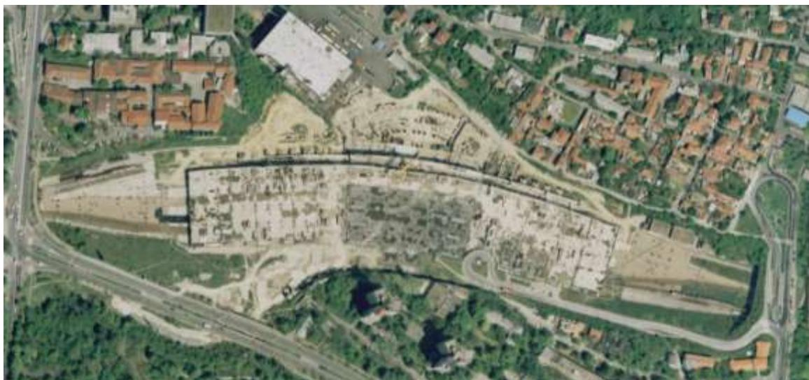
Jedna od najvećih i najkompleksnijih konstrukcija u okviru železničkog čvora je armirano betonska konstrukcija do kote 105. Stubovi ove konstrukcije počinju od donjeg stroja stanice do betonske ploče dužine 400 m i širine 100 m. Dubine temelja stubova, koji nose ovu konstrukciju su i do 14 m.
