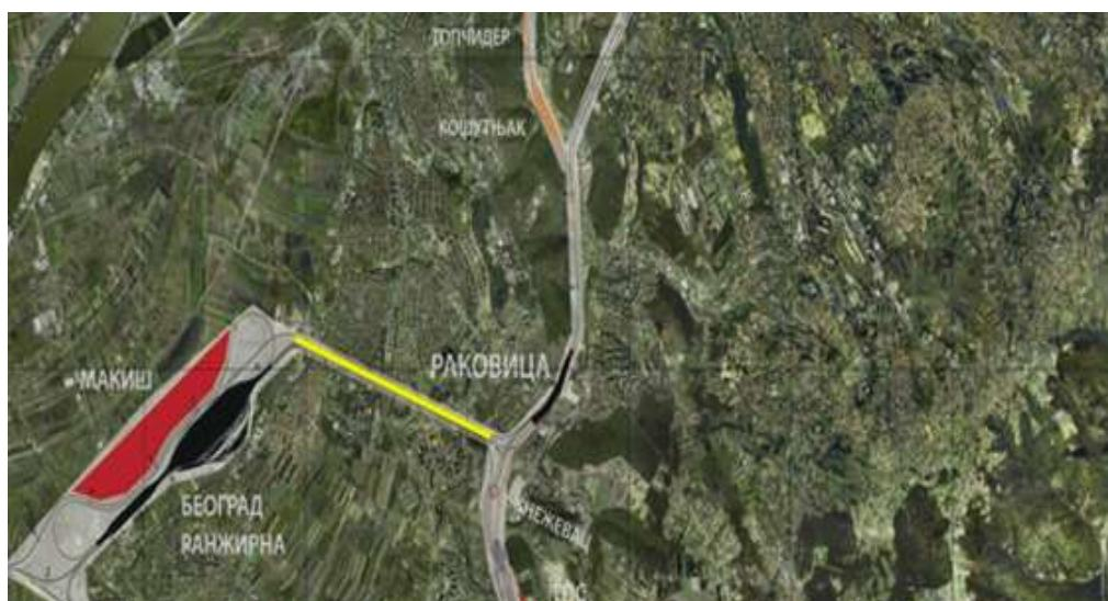
Izgradnjom stanice Rakovica stvorena je mogućnost za izgradnju pruge Rakovica - Ranžirna Makiš. Tuneli Kneževac (leva i desna tunelska cev), koji povezuju dvokolosečnu prugu Topčider - Resnik sa Ranžirnom stanicom, izgrađeni su u vremenu izgradnje stanice Makiš, šezdesetih godina. Da bi se izgradila dvokolosečna pruga Rakovica - Makiš, bilo je potrebno izvesti sledeće objekte:
